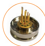
Сенсор КНК с мембраной из нержавеющей стали
